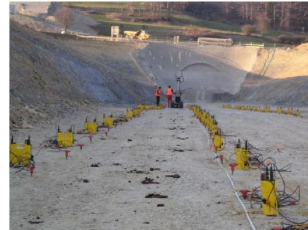
Geometrie des Reflexions/Refraktionsexperiments. Drei Phasen werden bei größeren Distanzen beobachtet: die direkte Welle, die reflektierte Welle und die refraktierte Welle.
